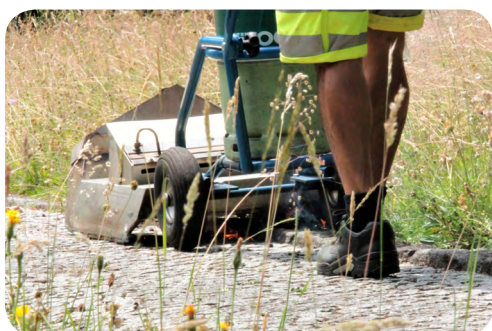
Abb. 42: Das Abflammen stellt eine ressourcenintensive und wenig effektive Methode zur Entfernung von Bewuchs dar.
